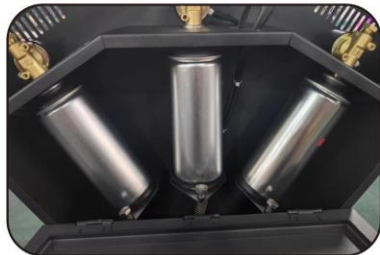
3. Richten Sie die Düse der Sprühölflasche mit der Maschinenschnittstelle aus
