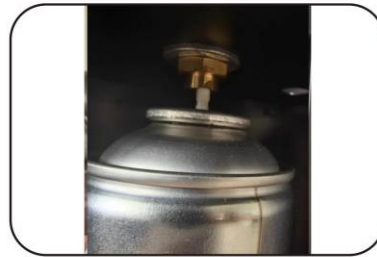
2. Placez l'huile de pulvérisation dans le disque et appuyez vers le bas.
