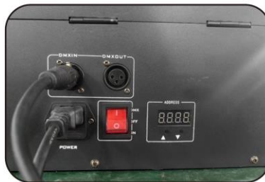
4. Collegare il cavo di alimentazione, accendere l'interruttore e collegare il controllo DMA.
