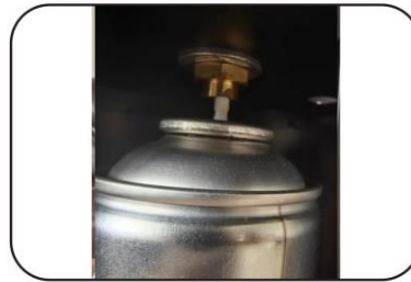
2. coloque el aceite de pulverización en el disco y presione hacia abajo.
