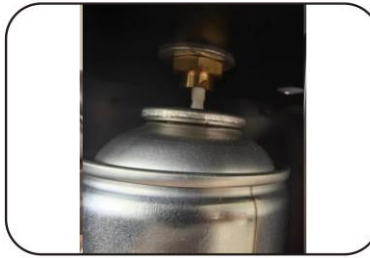
2. Legen Sie das Sprayöl in die Scheibe und drücken Sie es nach unten.
