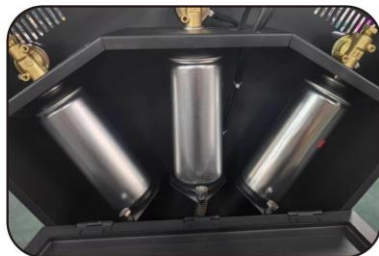
3. alinear la boca de la botella de aceite de pulverización con la interfaz de la máquina
