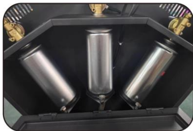
3. Allineare l'ugello della bottiglia dell'olio spray con l'interfaccia della macchina
